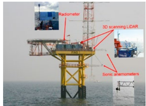
Test verschiedener Arten von Sensoren und technischen Geräten zum Offshore-Wind.
