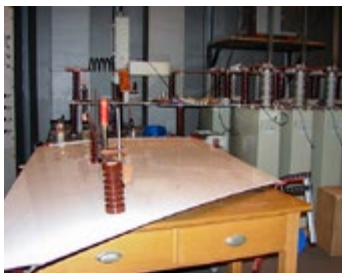
Blitzstrompunkt auf dem Seitenleitwerk (Abb.1)
