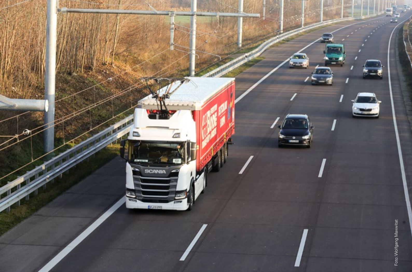
2017 fällt der Startschuss zum Bau einer Teststrecke auf der A1 zwischen Reinfeld und Lübeck, auf der elektrisch angetriebene Oberleitungs-Lkw drei Jahre lang Testergebnisse liefern sollen. Die Erprobung der Oberleitungstechnologie ist ein wichtiger Baustein zur Erreichung eines emissionsfreien Güterverkehrs. Im Dezember 2019 wurde die Teststrecke freigegeben.
